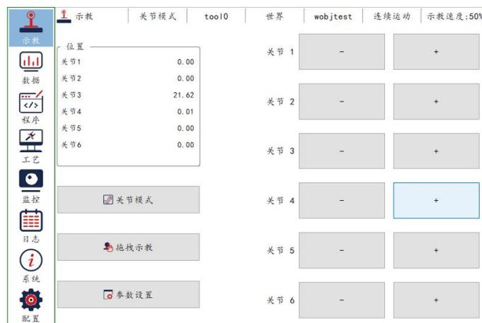
5) 上使能点动机械臂。当示教器背面的使能按钮按下时，示教器界面上显示
