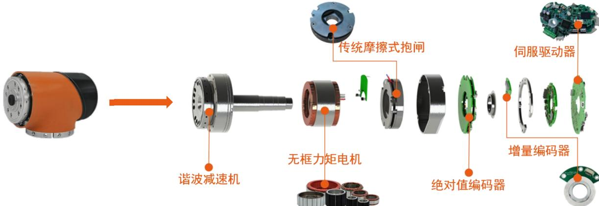
RJSII 关节模组集谐波减速机、无框力矩电机、制动器、增量编码器、绝对值编码器、伺服驱动器于一体，结构紧凑，便于安装。采用自主研发的伺服驱动器和双编码器实现全闭环控制，单关节重复定位精度小于 0.015°。RJSII 关节模组有 14S-40 多种型号可选，让机器人开发更简单、更便捷、更灵活自由。
