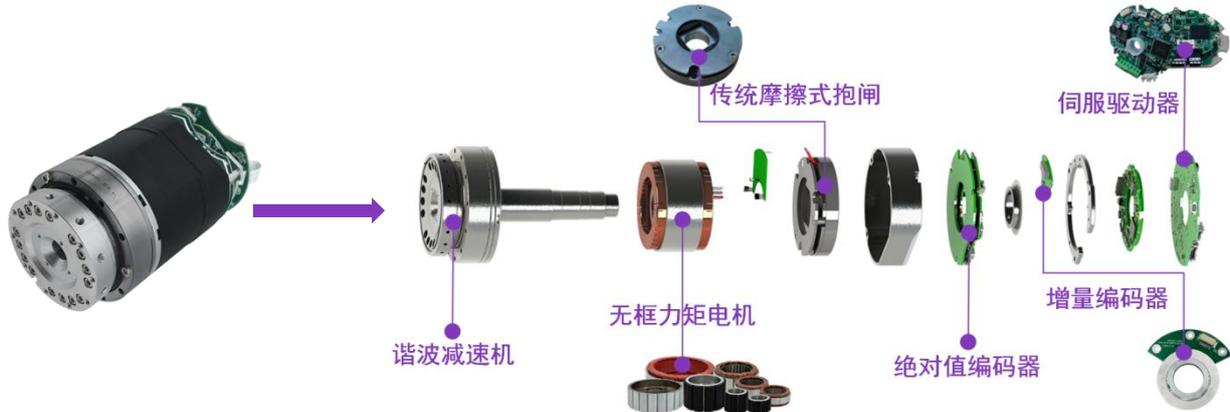
RJSIIZ 关节模组集谐波减速机、无框力矩电机、制动器、增量编码器、绝对值编码器、伺服驱动器于一体，结构紧凑，便于安装。采用自主研发的伺服驱动器和双编码器实现全闭环控制，单关节重复定位精度小于  $0.015^\circ$ 。RJSIIZ 关节模组有 14S-40 多种型号可选，让机器人开发更简单、更便捷、更灵活自由。
