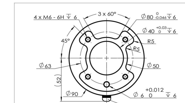
工具法兰 Tool flange
